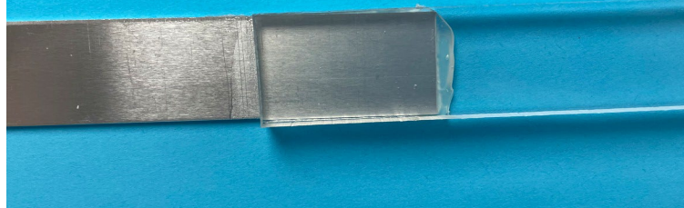
SCIGRIP 46C dimostrato durante il fissaggio di plastica con il metallo con presa traslucida.
